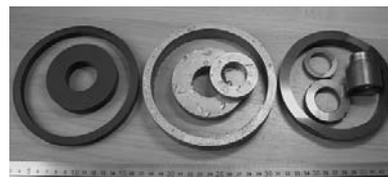
Рис. 1. Последовательность получения карбидокремниевой конструкционной керамики: карбидкремний-углеродные заготовки (слева); заготовки после силицирования (в середине); финишные изделия после механической обработки (справа).
